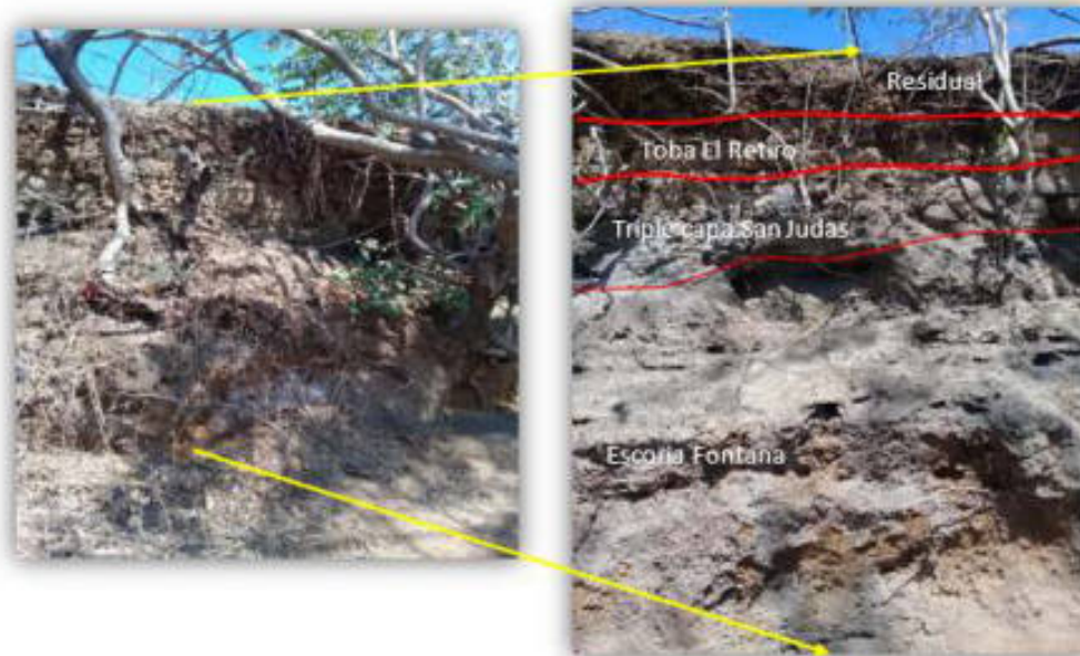
Ilustración 24: Afloramiento en las coordenadas 582985 E, 1333471 N. a 314 m.s.n.m. Se logra identificar diferentes unidades litológicas correspondientes a depósitos característicos de los suelos que conforman la estratigrafía de Managua
