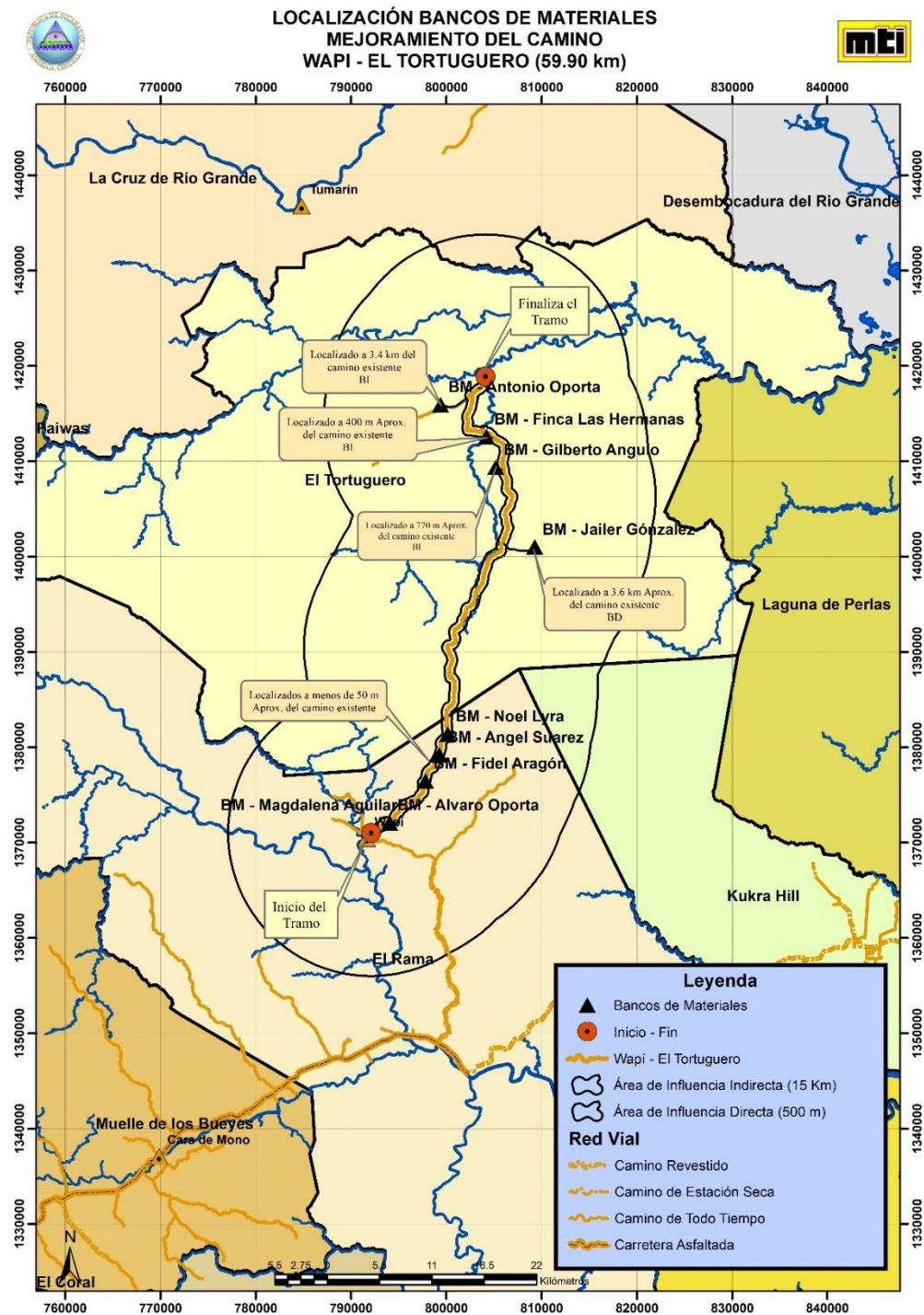
Figura 5.7.a: Localización Bancos de Materiales
