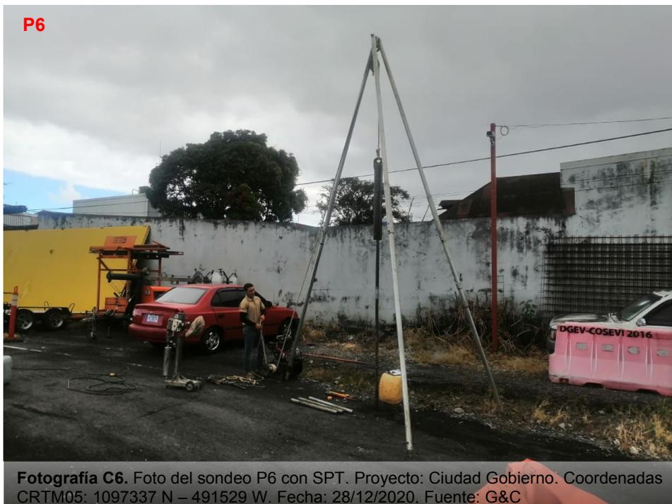
**Fotografía C6.** Foto del sondeo P6 con SPT. Proyecto: Ciudad Gobierno. Coordenadas CRTM05: 1097337 N – 491529 W. Fecha: 28/12/2020. Fuente: G&C
