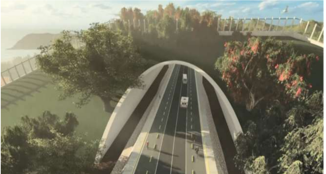
Ilustración 65 Esquema del paso ecológico tipo túnel
