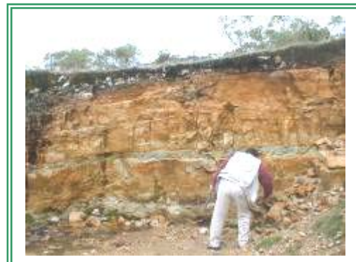
Fotografía 10 Estación 10. Areniscas y lutitas en sitio de extracción en Chermalito. Capas orientadas 18 grados al NE. Suelo de poco espesor con materia orgánica.
