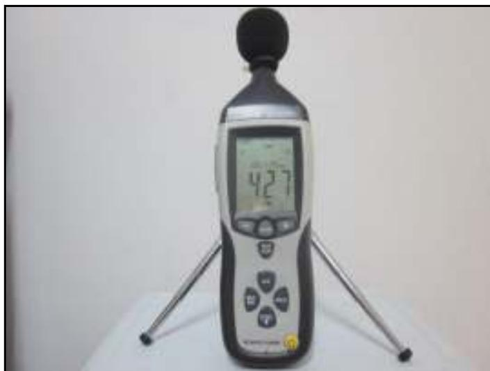
*Foto 7.2.3-4. Sonómetro marca CEM DT-9952 (IEC-61672-1 CLASS 2).*
