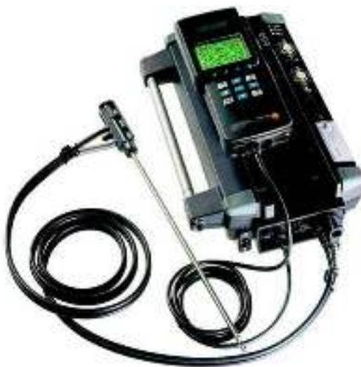
*Foto 7.3.3-1. Analizador portátil de gases TESTO 350 XL.*
