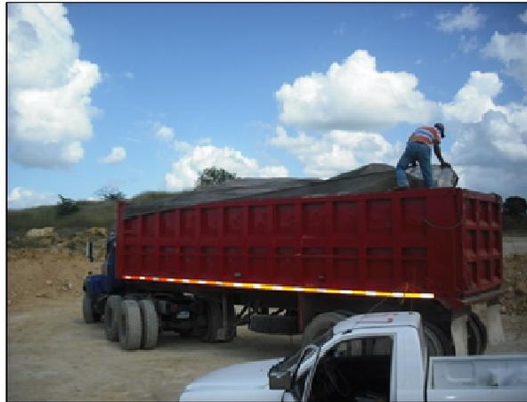
*Foto 4.1-2. Vista de trabajador cubriendo la carga de un camión con una lona.*
