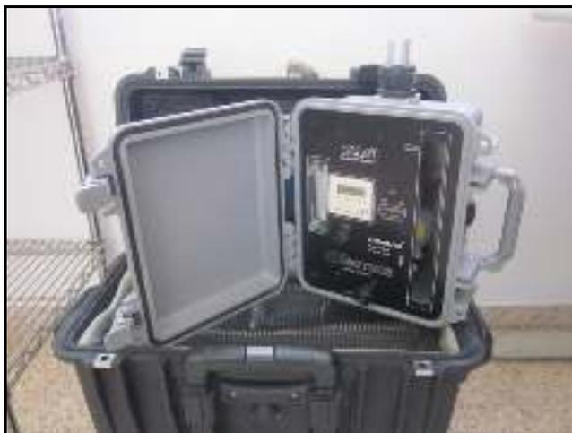
*Foto 7.2.3-2. Medidor portátil de material particulado Minivol TAS de Air Metrics.*
