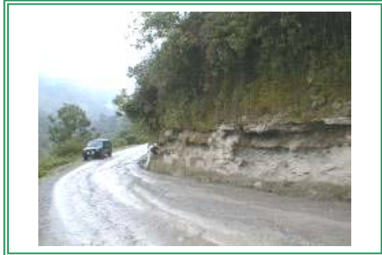
Fotografía 9. Punto observado 5, afloramiento de lutitas verdosas calcáreas con estratificación sub-horizontal de la unidad de capas rojas.
