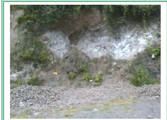
Fotografía 11. Punto observado 9, Afloramiento de lutita calcárea en la zona de contacto entre lutitas y caliza brechosa. Material deleznable, meteorizado, fácilmente erosionable.
