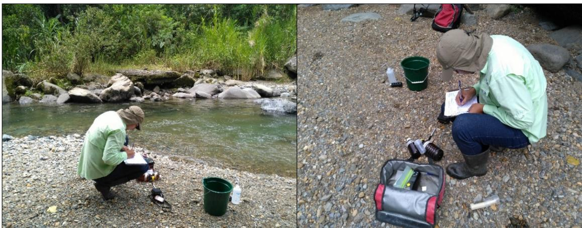
**Figura 7.5.23.** Panorámica de técnica de muestreo para la toma de muestras para determinar la calidad de agua fisicoquímica en cada una de las 39 localidades de muestreo acuático del AI del PVAAM. 2017.
