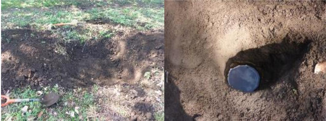
Fotografías 1 y 2: excavación para la prueba tipo Porchet.
