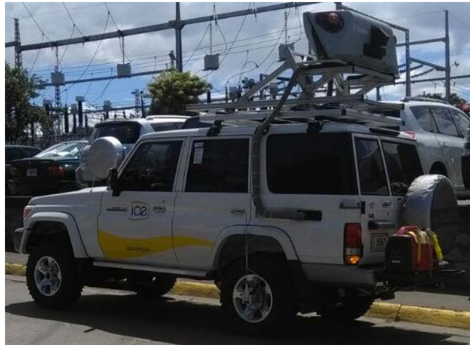
Ilustración 20 Vehículo utilizado para el levantamiento LIDaR
