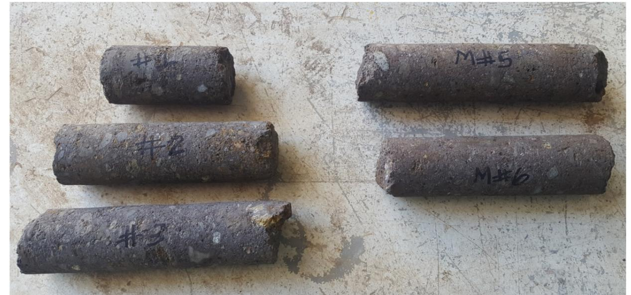
Foto 5-3: Muestras de mano de la ignimbrita en condición alterada extraída de las cajas de perforación R1 y R2
