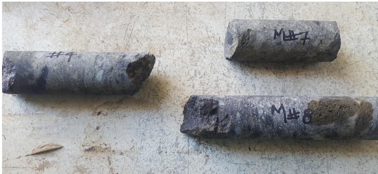
Foto 5-4: Muestras de mano de la ignimbrita en condición ligeramente alterada a sana extraídas de las cajas de perforación R1 y R2
