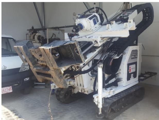
Foto 3-1: Equipo de perforación utilizado para la ejecución de las perforaciones a rotación.
