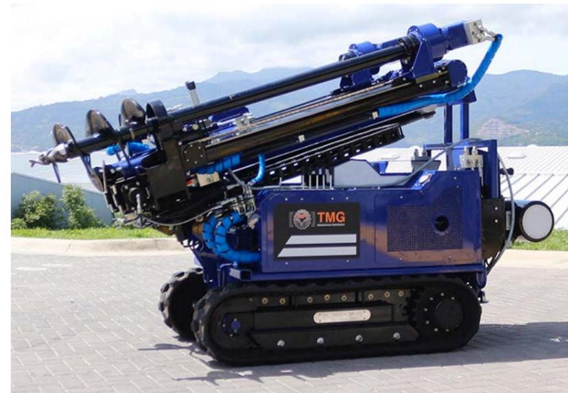
Foto 3-3: Equipo utilizado para las pruebas CPTu
