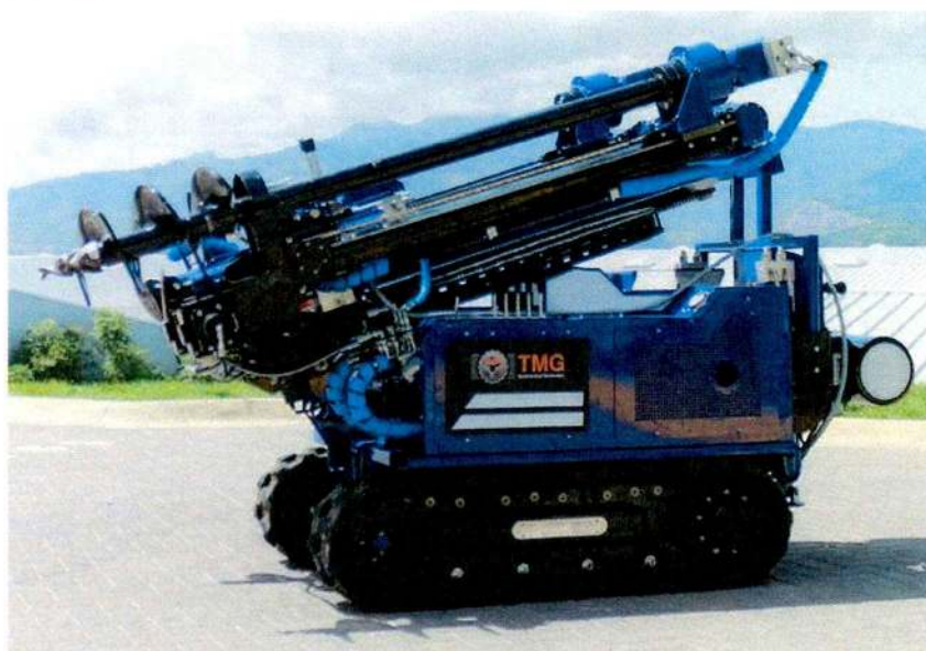
Foto 0: Equipo utilizado para las pruebas CPTu
