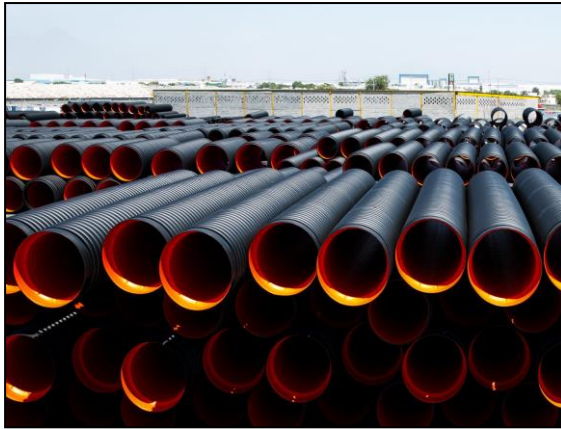
Fig 1. Tubos de PEAD lisos y corrugados utilizados internacionalmente en las redes de alcantarillado y acueducto.
