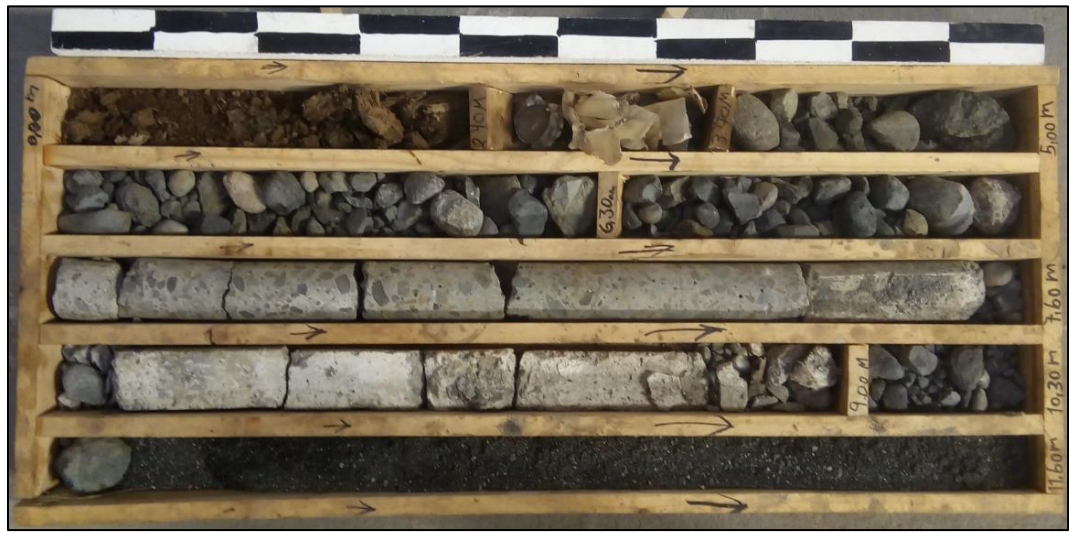
Fotografía 10. Muestra de suelos sondeo S-2 Pila 1 (MI). Prof. 0,00 m - 11,60 m
