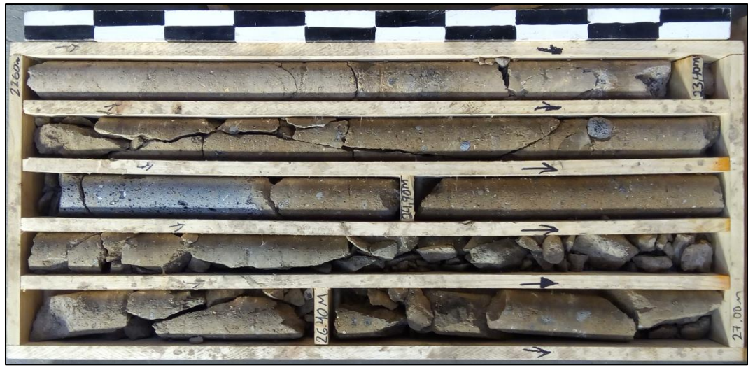
Fotografía 29. Muestra de suelos sondeo S-4 Pila 3 (MI). Prof. 22,60 m - 27,00 m
