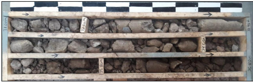
Fotografía 36. Muestra de suelos sondeo S-5 Pila 4 (MD). Prof. 31,60 m - 36,80 m
