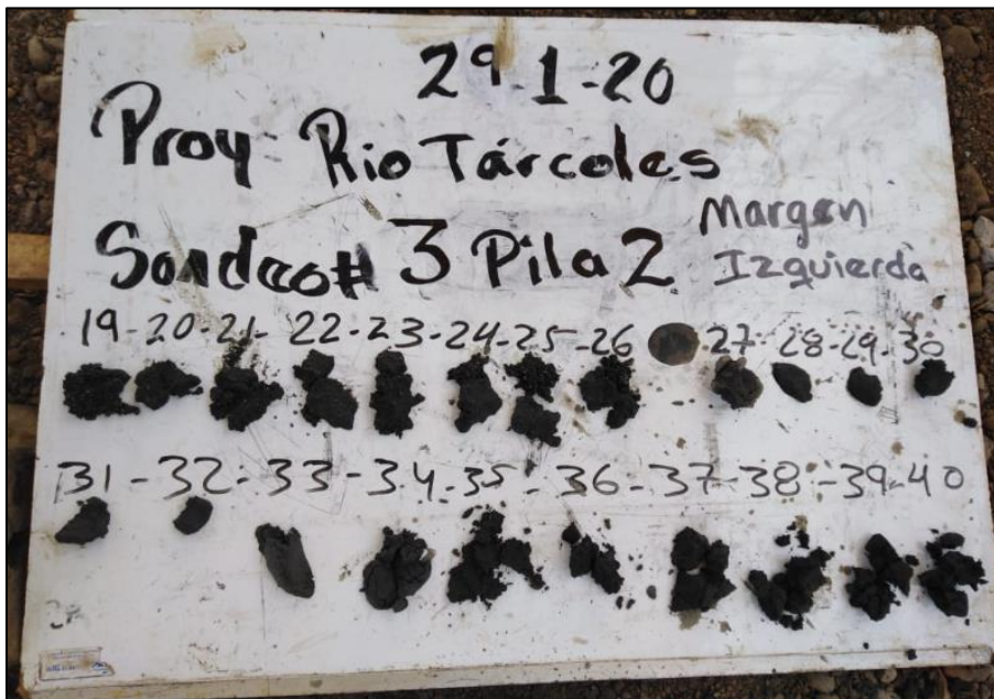
Fotografía 19. Muestra de suelos sondeo S-3 Pila 2 (MI). Prof. 9,00 m - 20,00 m
