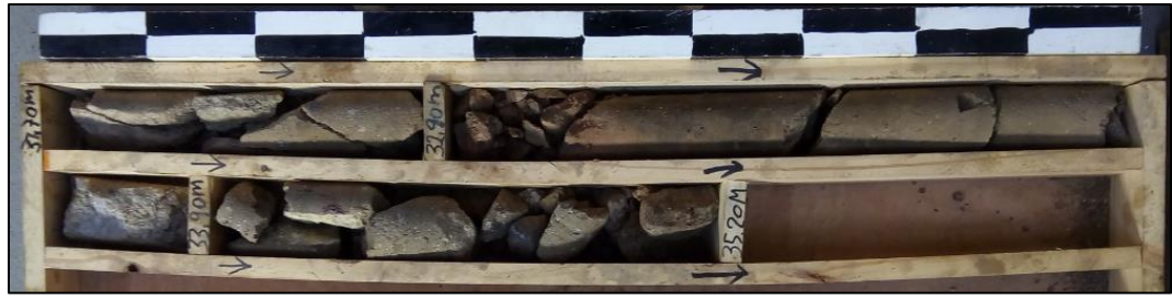
Fotografía 31. Muestra de suelos sondeo S-4 Pila 3 (MI). Prof. 31,70 m - 35,20 m
