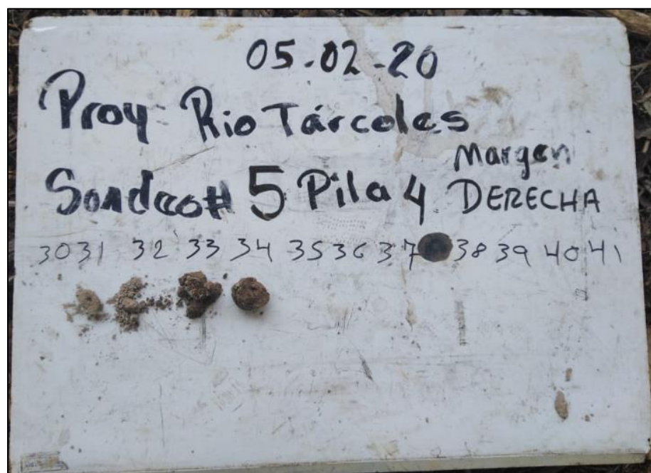
Fotografía 33. Muestra de suelos sondeo S-5 Pila 4 (MD). Prof. 15,00 m - 17,00 m
