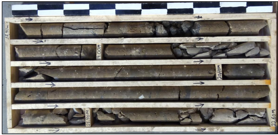
Fotografía 28. Muestra de suelos sondeo S-4 Pila 3 (MI). Prof. 17,90 m - 22,60 m
