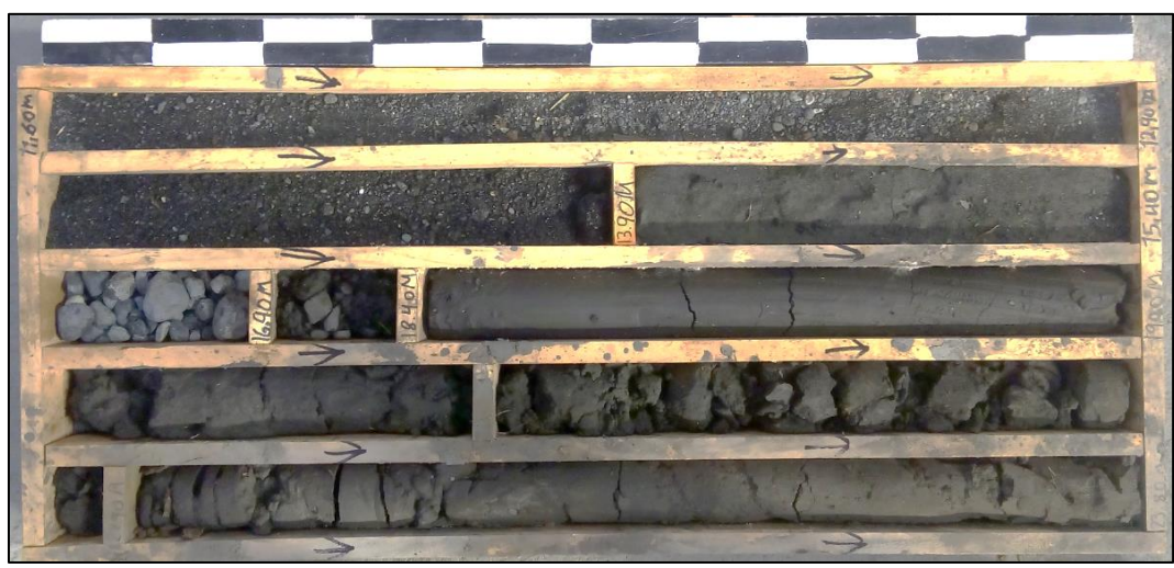
Fotografía 11. Muestra de suelos sondeo S-2 Pila 1 (MI). Prof. 11,60 m - 23,80 m
