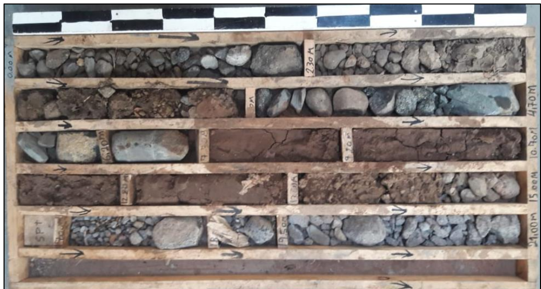
Fotografía 34. Muestra de suelos sondeo S-5 Pila 4 (MD). Prof. 0,00 m - 21,00 m
