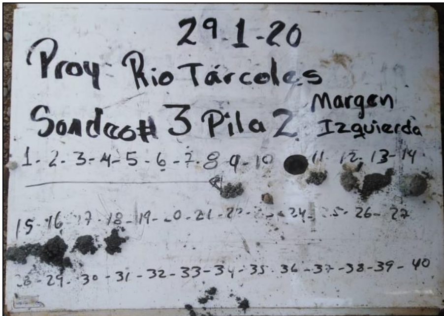
Fotografía 18. Muestra de suelos sondeo S-3 Pila 2 (MI). Prof. 4,00 m - 9,00 m
