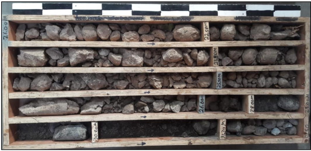
Fotografía 35. Muestra de suelos sondeo S-5 Pila 4 (MD). Prof. 21,00 m - 31,60 m
