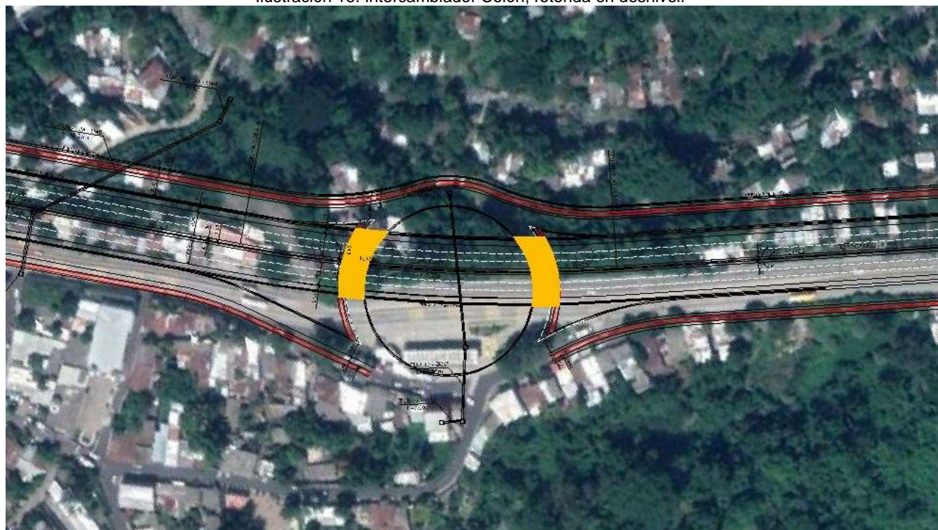
Ilustración 16. Intercambiador Colón, rotonda en desnivel.
