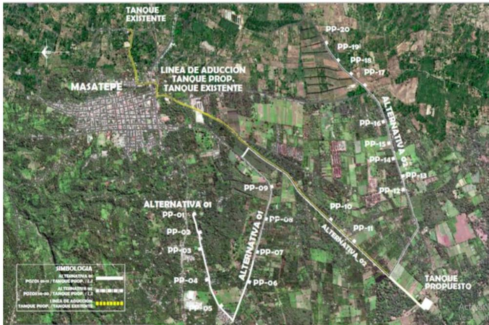
**FIGURA 27. VISTA SATELITAL DE LOCALIZACION DE COMPONENTES PROPUESTOS PARA EL SISTEMA AP**
