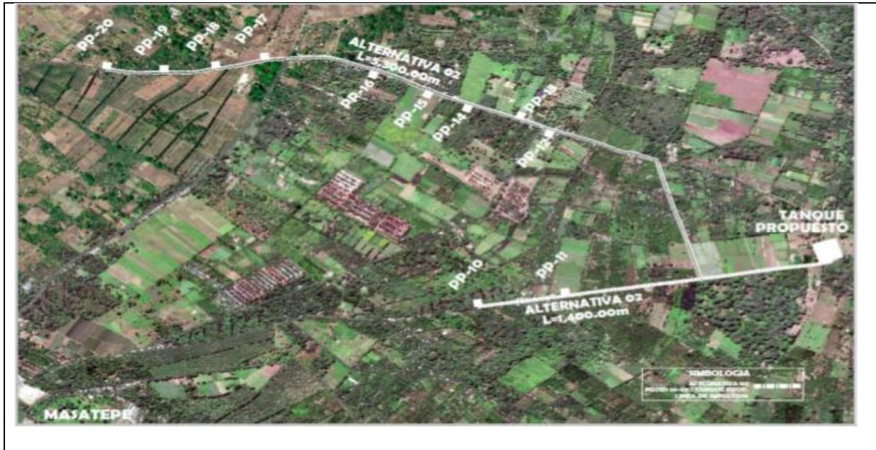
**FIGURA 13. IMAGEN DE ALTERNATIVA 01 Y 02 PROPUESTO PARA EMPLAZAMIENTO DE POZOS**
