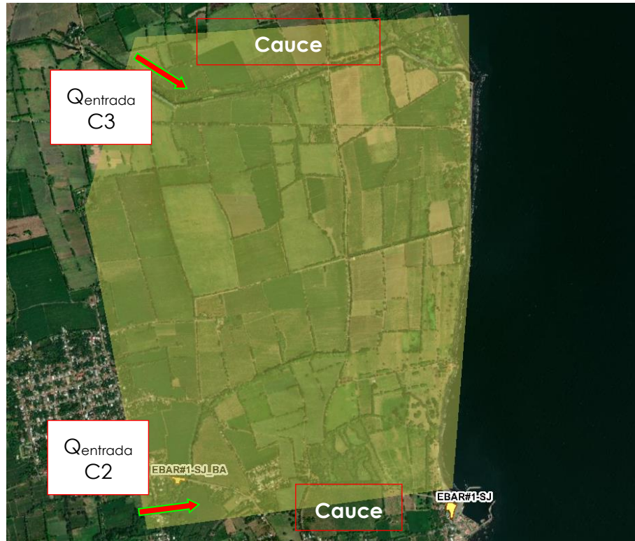
Figura 33 Condición de contorno (entrada) aguas arriba en IBER. Modelo San Jorge – Buenos Aires Sur.
