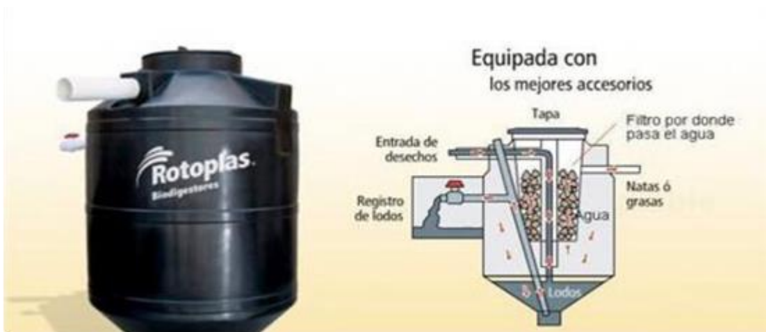
Figura 12: Solución individual de saneamiento Propuestos
