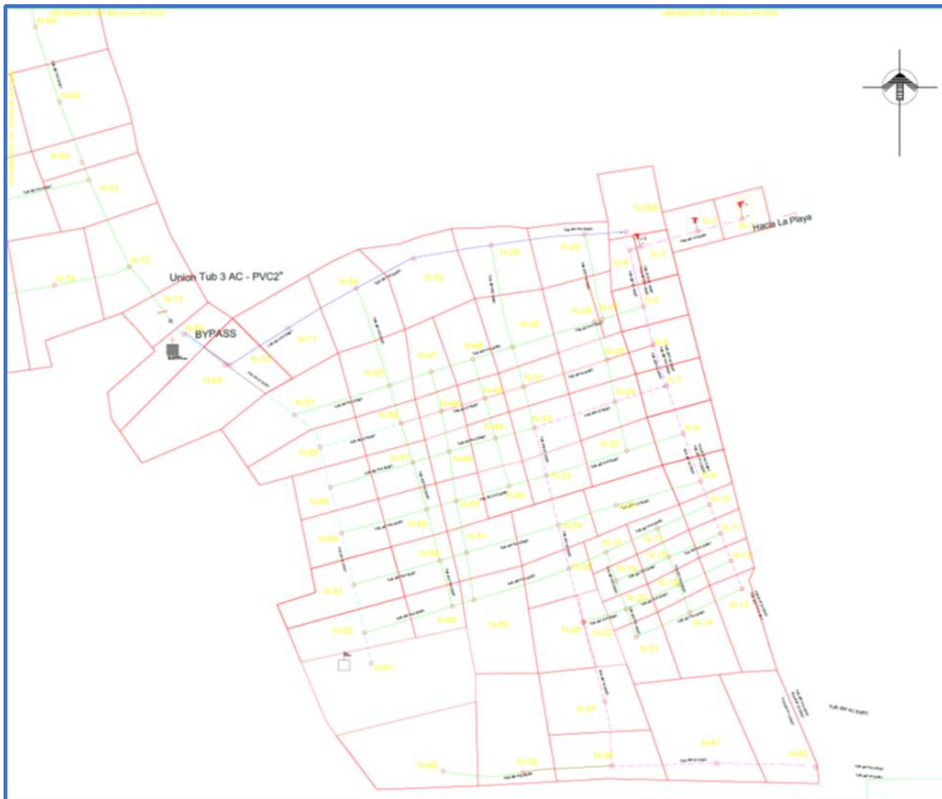
Figura 21: Nodos que conforman la red de distribución de Buenos Aires
