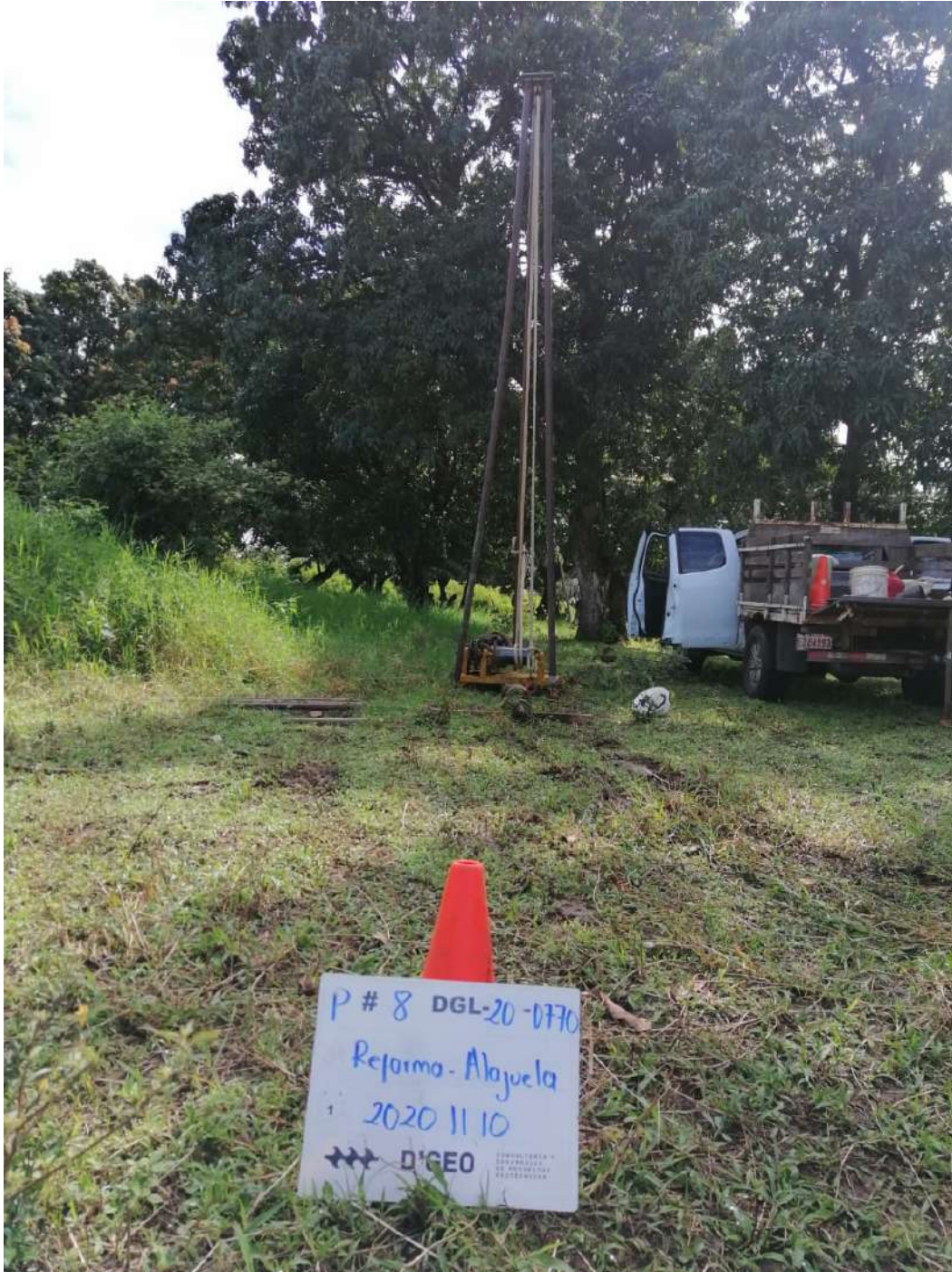
Fotografía #B.8 Fotografías de los sondeos SPT realizados. P-8.
