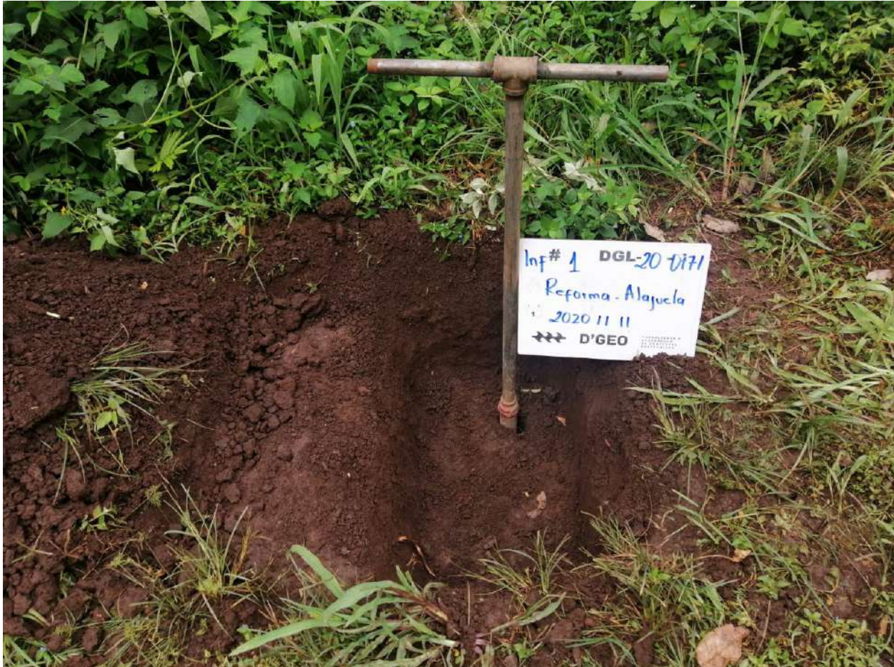
Fotografía #B.14 Fotografías de la infiltración realizada. INF-1.
