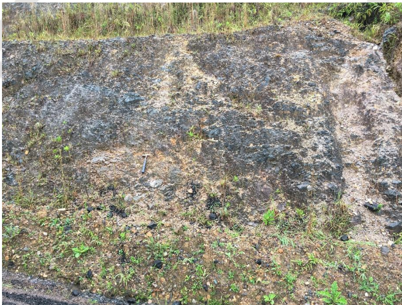
Afloramiento 20: Lutita meteorizada, Fm. Coris
