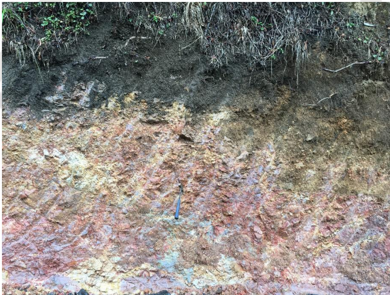
Afloramiento 18: Lutita meteorizada, Fm. Coris
