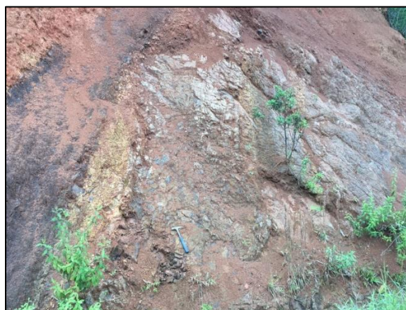
Foto 5.2.1. Caracterización de lutitas y areniscas
