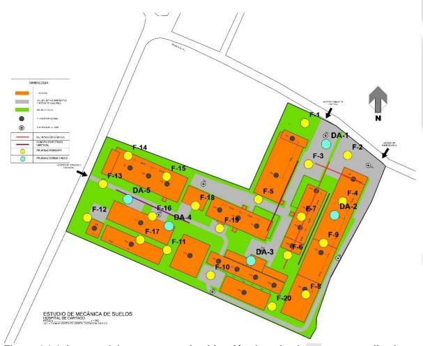
Figura 4.1.1. Imagen del proyecto con la ubicación de todos los ensayos realizados.
