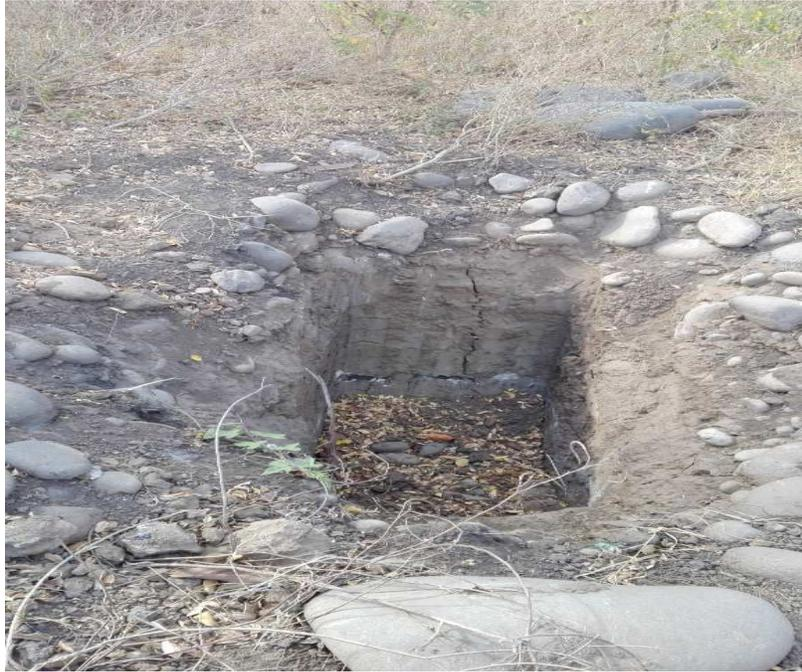
**Fotografía 7.3.** Material presente en la finca, el material se observa dentro de una trinchera realiza en el sitio, la cual permite observar bloques subredondeados de diversas dimensiones dentro de una matriz con textura variable, limo arenoso a arcilloso. **Fuente** Geocad Estudios Ambientales 2019.
