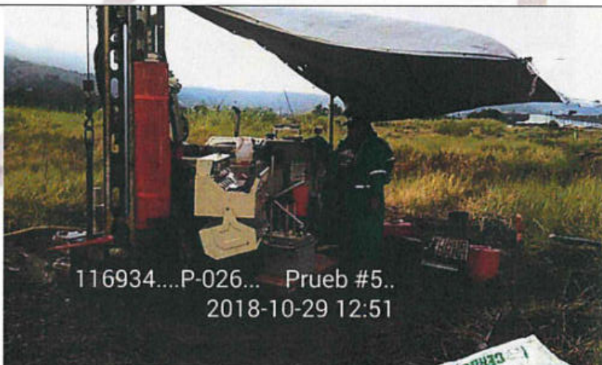
Proceso de la perforación P-26, equipo de rotación instalado en una zona con vegetación baja, de topografía bastante plana, y sin edificaciones.
