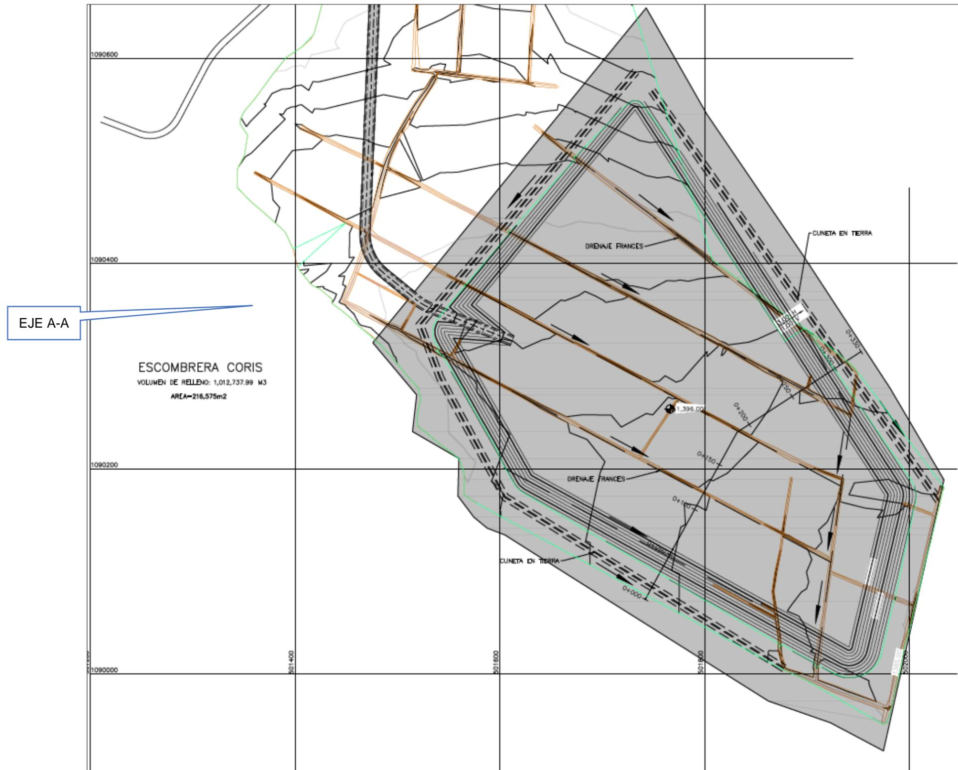
**Figura 7.1.157.** Propuesta geométrica (planta) de factibilidad para la conformación de la escombrera Coris.
