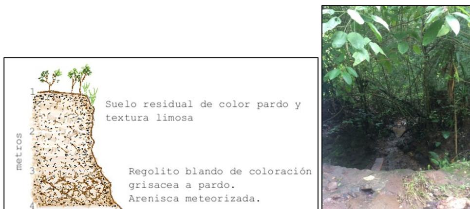
**Figura 7.1.87.** Esquema de las Unidades Geotécnicas y detalle del sitio en el paso PRQ-1. (Coordenadas CRTM05 Norte 1091644 Este 498539).
