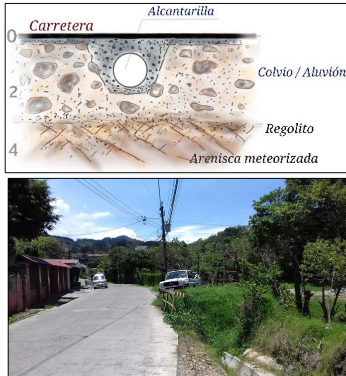
**Figura 7.1.93.** Esquema de las Unidades Geotécnicas y detalle del paso PRQ-7. (Coordenadas CRTM05 Norte 1091732 Este 496237).
