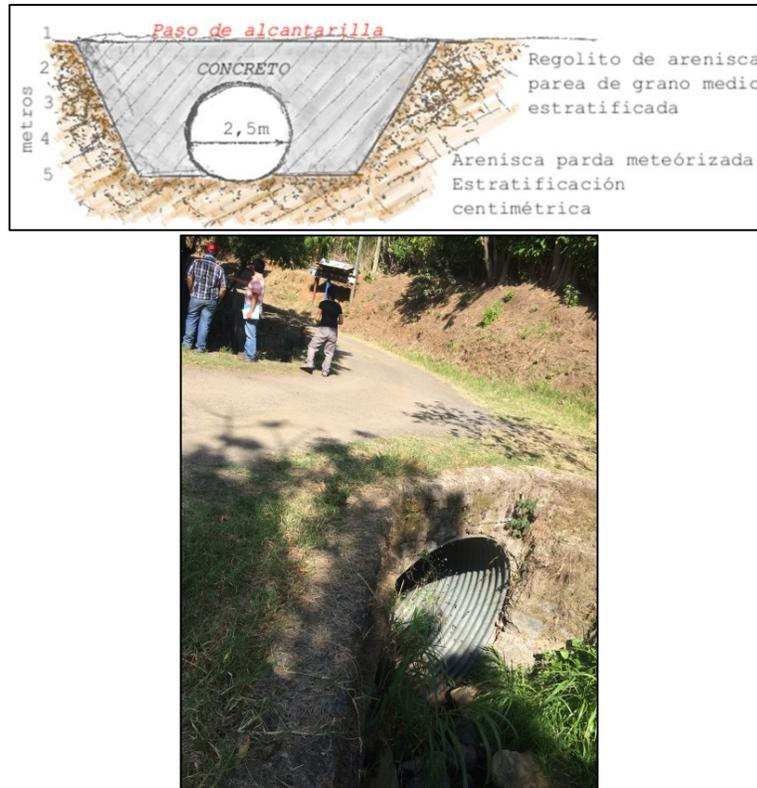
**Figura 7.1.88.** Esquema de las Unidades Geotécnicas y detalle del sitio en el paso PRQ-2. (Coordenadas CRTM05 Norte 1091973 Este 497767).
