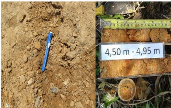
**Foto 5.** Brecha fina, bloques milimétricos hasta centimétricos con líticos de carbón.
