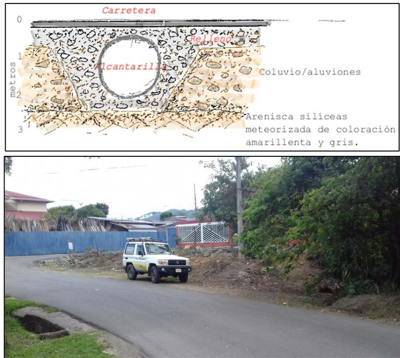
**Figura 7.1.91.** Esquema de las Unidades Geotécnicas y detalle del sitio en el paso PRQ-5. (Coordenadas CRTM05 Norte 1091915 Este 496431).
