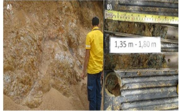
**Foto 8.** Brechas meteorizadas y alteradas.
