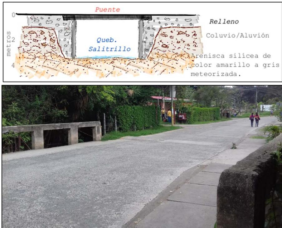
**Figura 7.1.92.** Esquema de las Unidades Geot3cnicas y detalle del sitio en el paso PRQ-6. (Coordenadas CRTM05 Norte 1091755 Este 496302).
