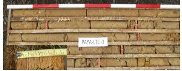
**Foto 2.** Material correspondiente al intrusivo fuertemente meteorizado (SPT-1 y LTLL-3).
