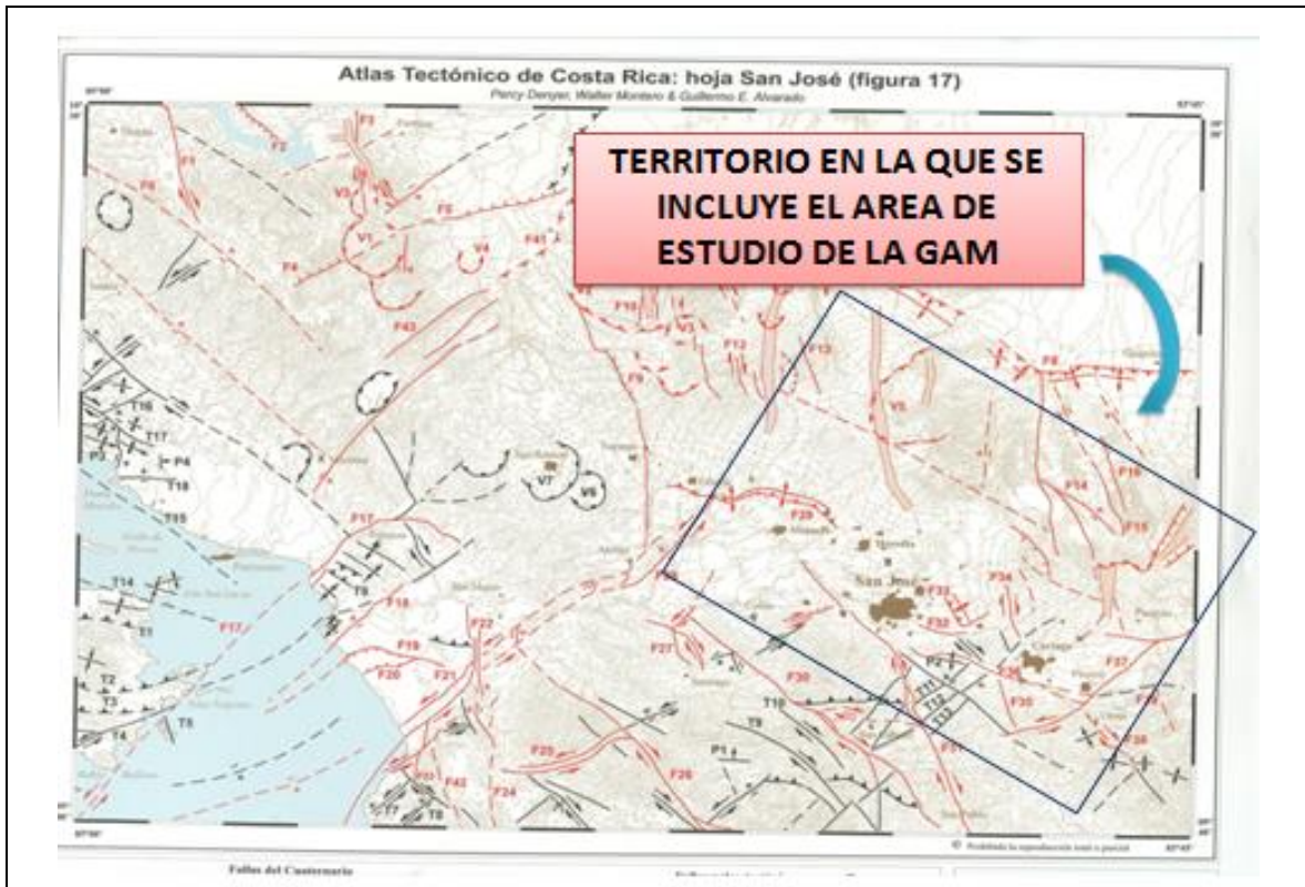
Figura 6.5. Mapa de la hoja San José, según el Atlas Tectónico de Costa Rica (cf. Denyer et al., 2003). Las fallas en rojo son fallas del Cuaternario. Las fallas en negro son fallas del Pre – Cuaternario.
